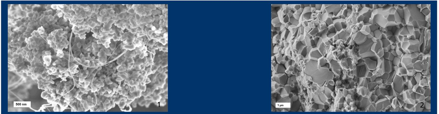
1 REM-Aufnahme von CNT-belegtem Keramikpulver.
